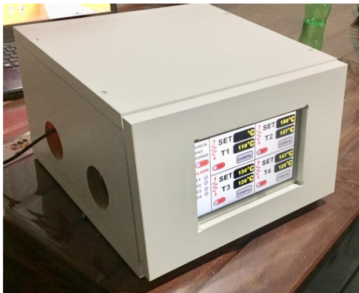
Figura 15- Gabinete do controlador
