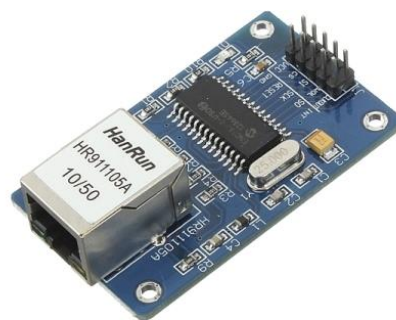
Figura 12 - Módulo Ethernet ENC28J60
