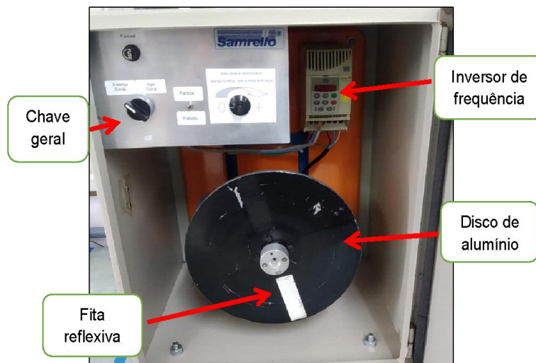
Figura 1: Padrão para calibração de tacômetro
