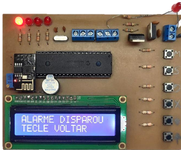
Figura 60 – Mensagem de “alarme Disparou”, sinalização sonora e visual
