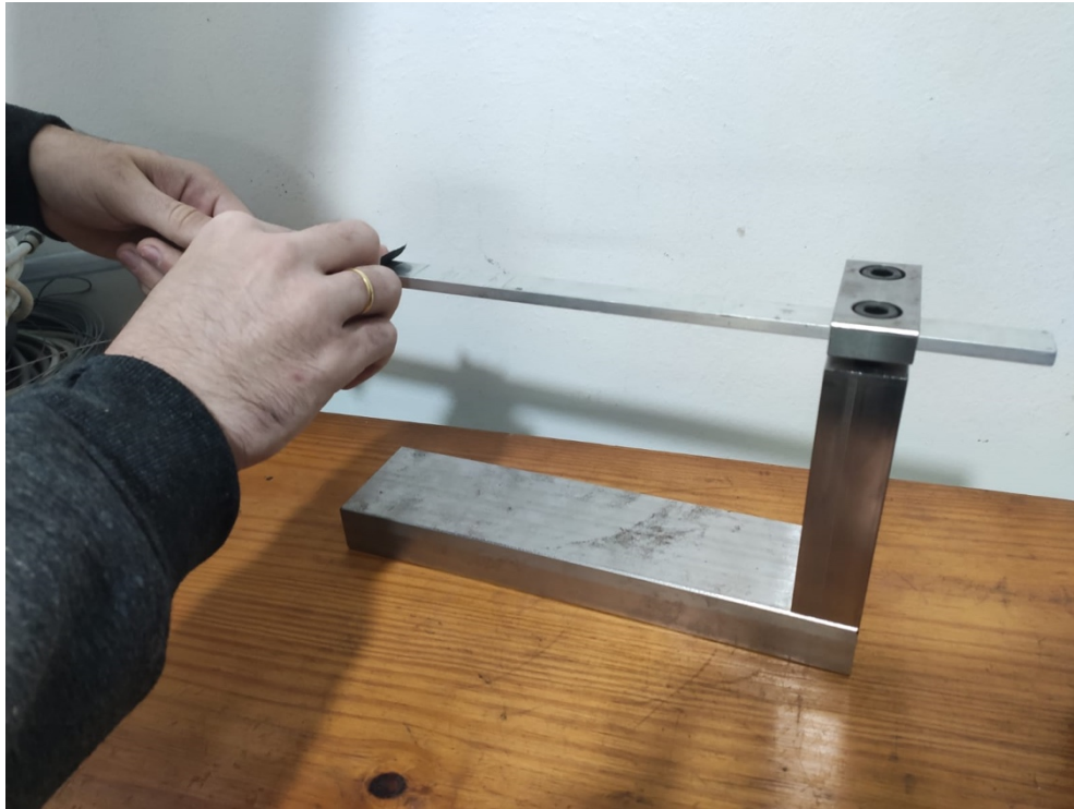
Figura 15 - Lixamento da superfície
