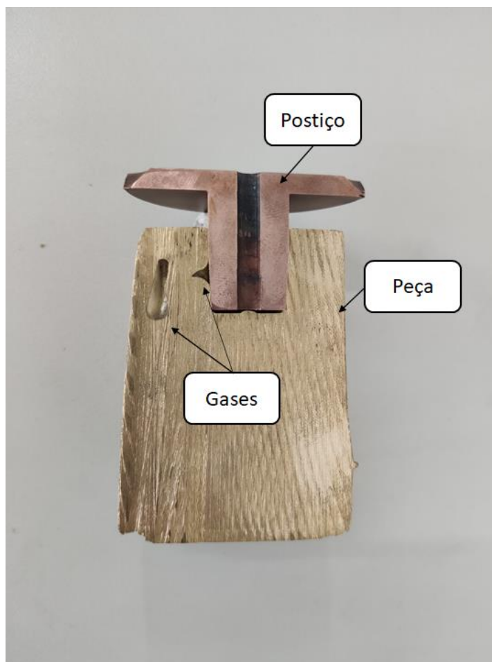
Figura 68 - Vista em corte da relação postigo e peça com defeito
