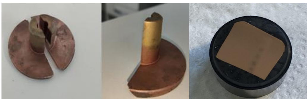
Figura 30 - Corte do postigo de cobre e amostra do postigo embutida
