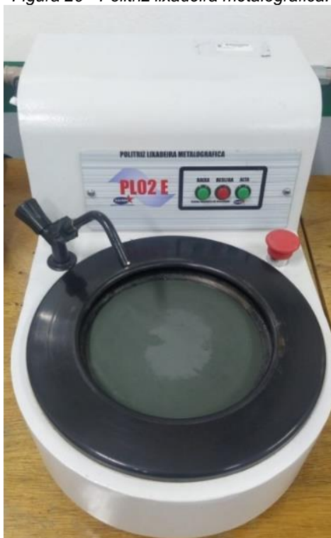
Figura 20 - Politriz lixadeira metalográfica.
