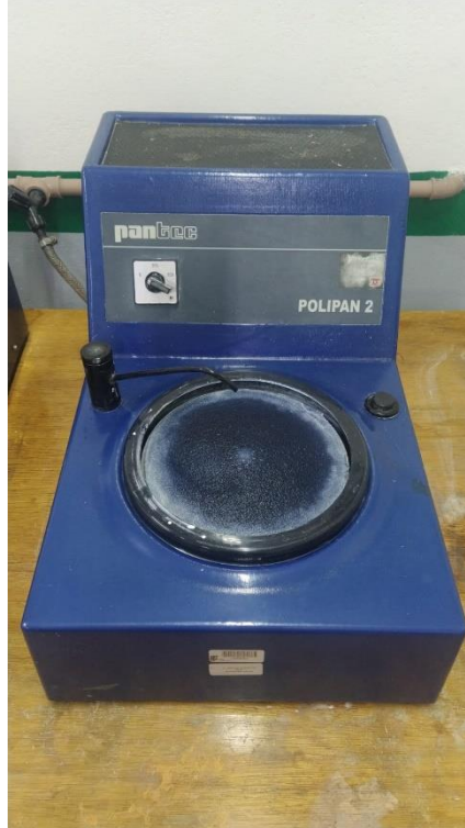
Figura 21 - Politriz automática metalográfica.
