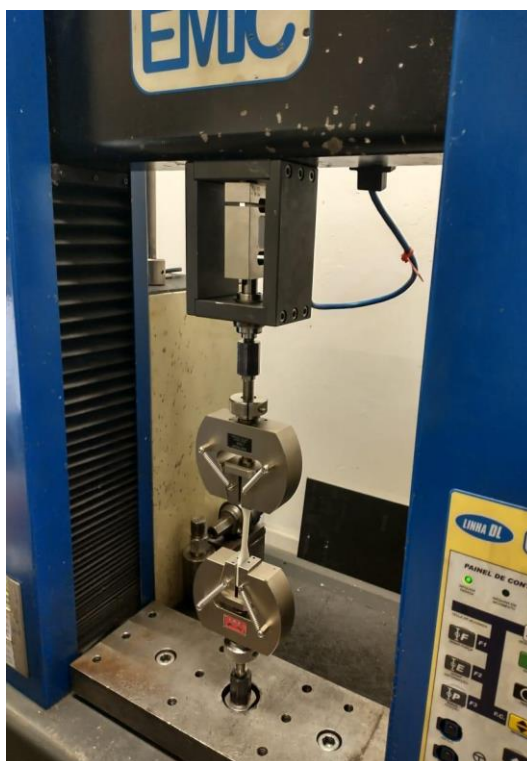
Figura 19 - Equipamento EMIC DL1000, perspectiva isométrica
