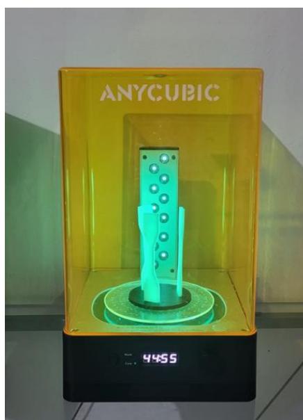
Figura 17 - Amostras na máquina de cura utilizando o gabarito de posicionamento
