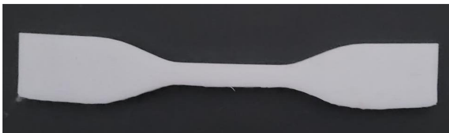
Figura 8 - Corpo de prova após a remoção dos suportes
