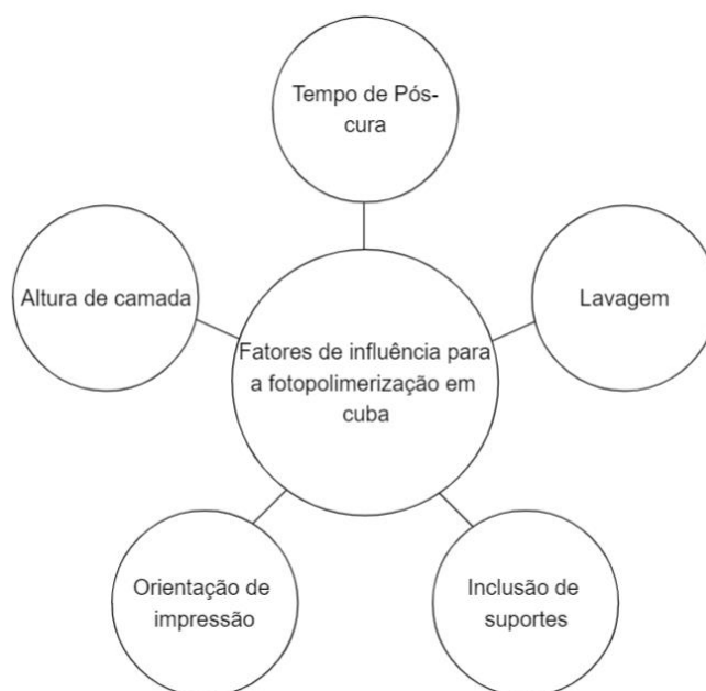
Figura 5 - Parâmetros de influência sobre as características dos materiais impressos em fotopolimerização por cuba
