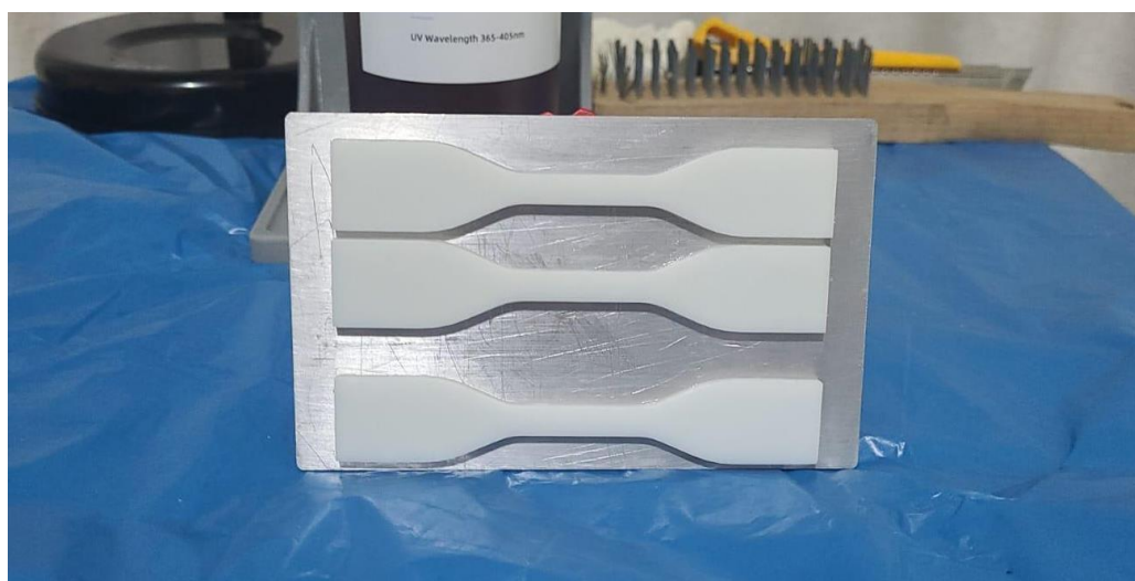
Figura 13 - Corpos de prova do tipo IV impressos na resina Tough UV
