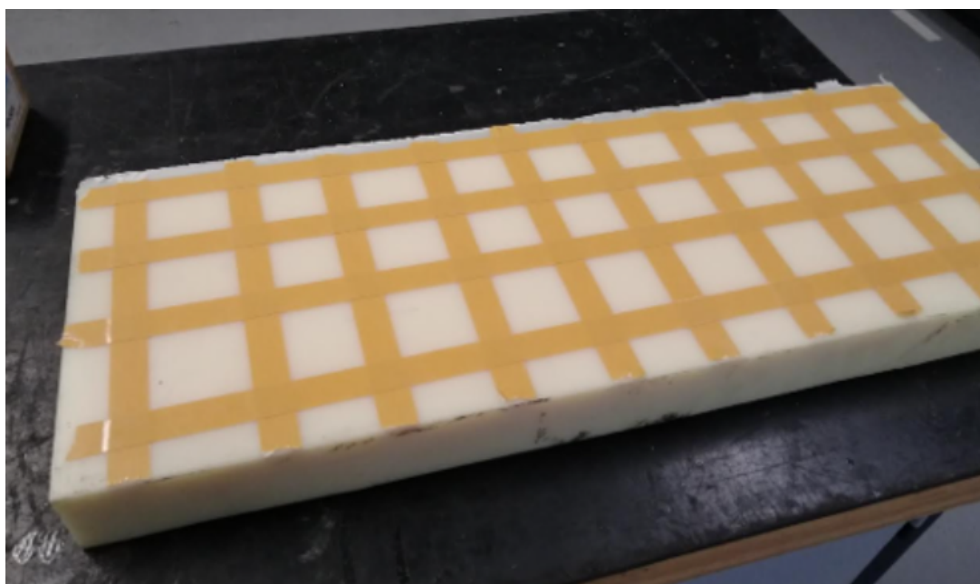
Figura 13 - Método de fixação da matéria prima
