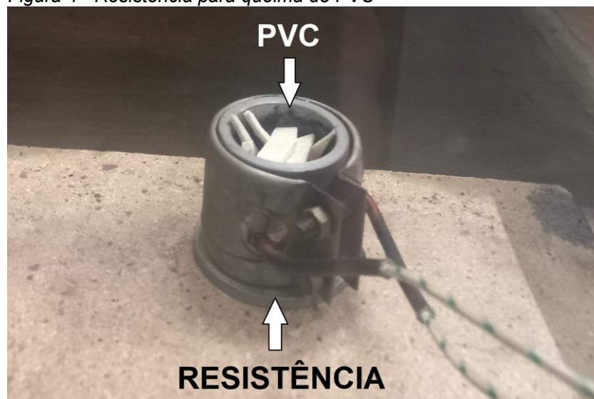
Figura 4 - Resistência para queima do PVC
