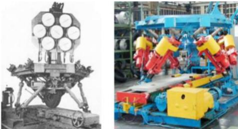
Figura 3 - Projeto original de Gough para testes de pneus de aeronaves (E) e versão moderna do aparato com atuadores elétricos(D).
