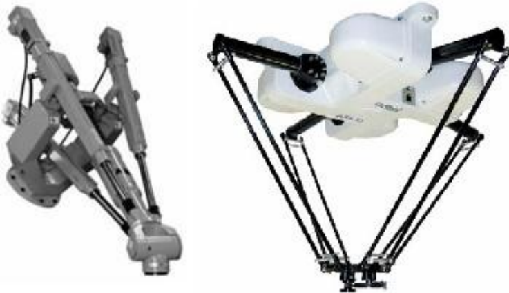
Figura 8 - Exemplo de Robô Paralelo - Tricept (E) e Adept Quattro(D). Fonte: www.pgene.ufabc.edu.br . Acesso em 19/05/13.
