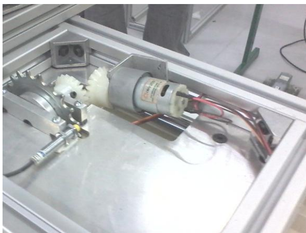
FIGURA 58 – Motor de movimentação - eixo “X ”. Fonte: Autores
