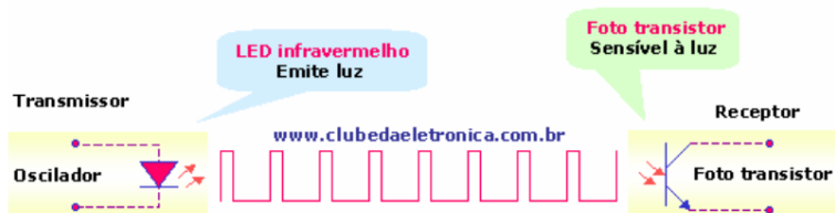
FIGURA 14 – Diagrama genérico de um sensor óptico
