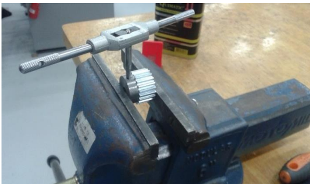
Figura 37 - Rosqueamento manual, parafuso de fixação da polia [Fonte: Autores].
