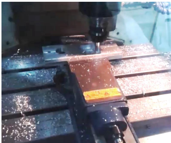
Figura 34 - Fabricação de peças em fresadora CNC (centro de usinagem) [Fonte: Autores].
