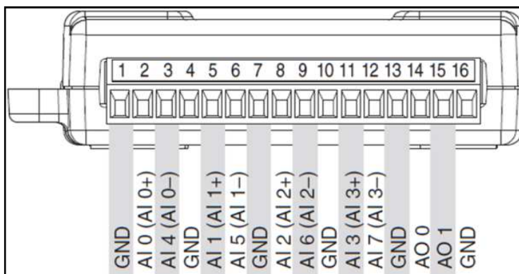
FIGURA 22 - Pinagem e ligação da placa NI USB-6009 Fonte: Manual de instruções NI USB-6009
