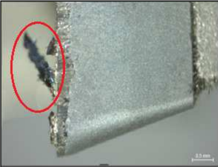
FIGURA 39 - Adesão de metal na ferramenta de corte Fonte: Os autores
