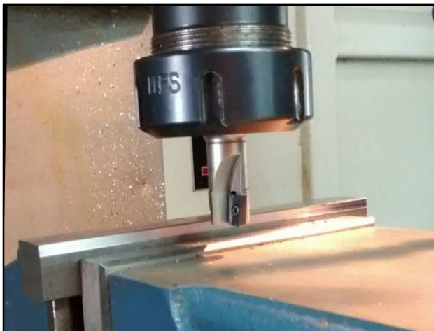
FIGURA 31 - Corpo de prova fixado na morsa Fonte: Os autores
