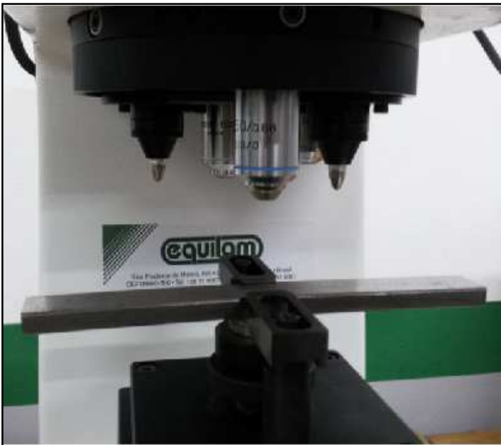
FIGURA 32 - Fixação do corpo de prova no durometro Fonte: Os autores
