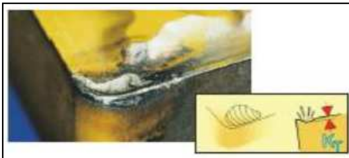
FIGURA 6 - Desgaste de cratera
