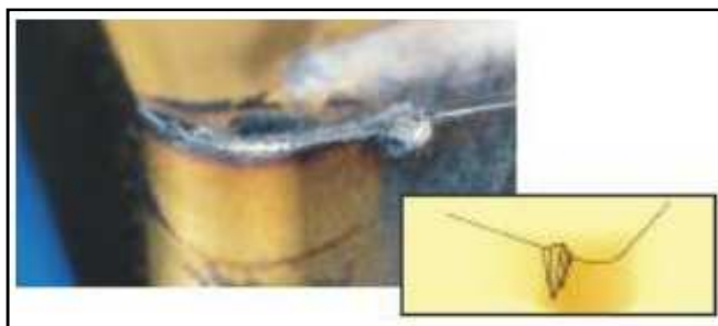
FIGURA 7 - Desgaste de entalhe Fonte: SANDVIK, 2014
