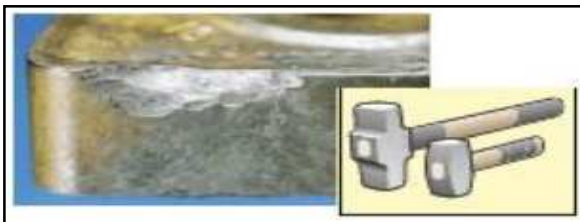
FIGURA 11 - Lascamento da ferramenta Fonte: SANDVIK, 2014
