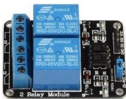
FIGURA 11 – Módulo relé 5V 10A de 2 canais
