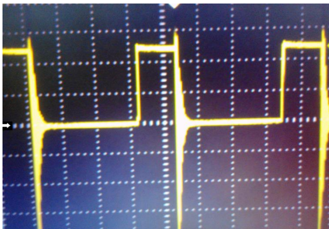
Figura 39 - Tensão no Diodo ( 50\text{ V/div} ; 10\mu\text{s/div} ).
