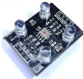
Figura 14: Sensor TCS230 Fonte: Site SEJALIVRE
