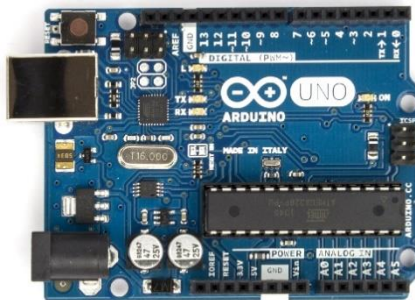
Figura 13: Visão frontal Arduino Uno Fonte: Datasheet ARDUINO UNO.
