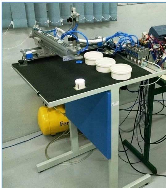
Figura 10: Mesa pneumática XY Fonte: Autores
