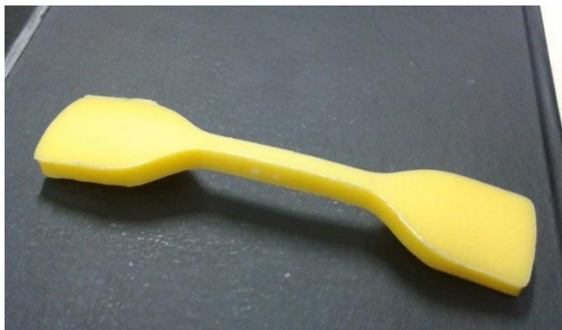
Figura 20: Corpo de Prova em PEAD
