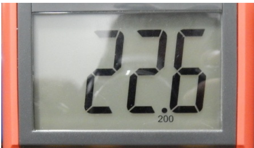
Figura 56 – Resistência equivalente de saída do conversor Buck valor em ohms
