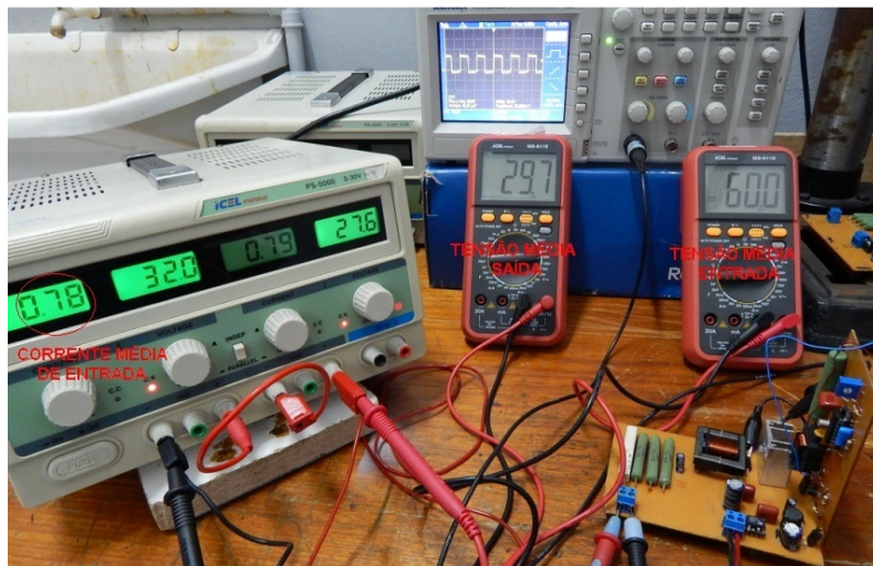
Figura 55 - Tensões na entrada e na saída do conversor Buck.
