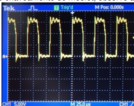
Figura 66. Interferência no PWM (5v/div, 25us/div).
