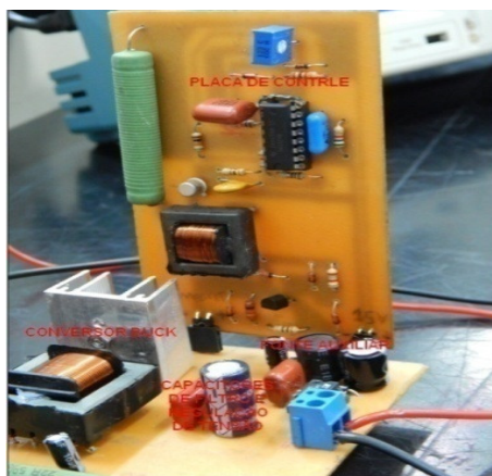
Figura 54 - Placa de comando acoplada ao conversor.
