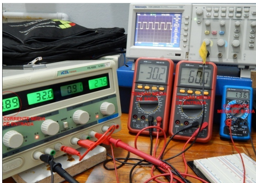
Figura 61 - Tensões e correntes médias para conversor Buck-Boost.
