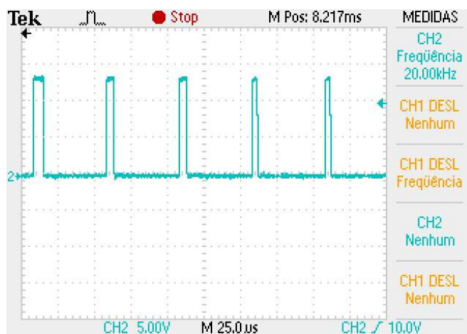
FIGURA 46 - Razão cíclica inicial SPWM
