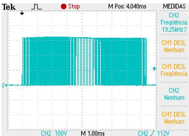
FIGURA 53 - Tensão na chave S2 inversor
