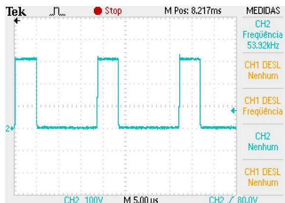
FIGURA 51 - Tensão na chave Boost 2
