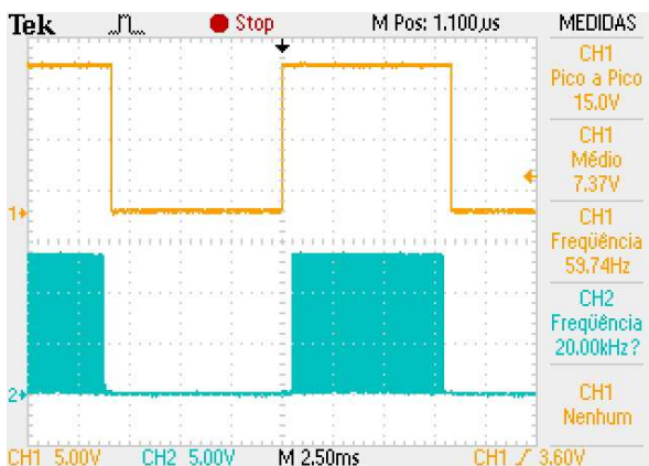
FIGURA 45 – Comando complementar inversor
