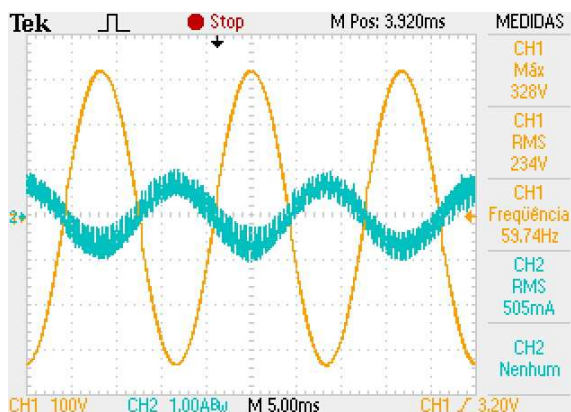
FIGURA 49 - Tensão e corrente de saída do conversor
