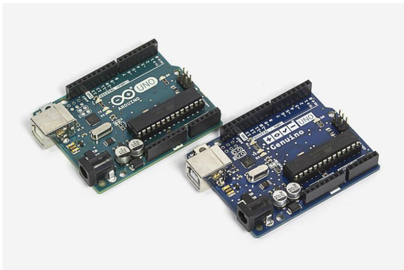
Figura 6 - Modelo de Arduino na versão UNO
