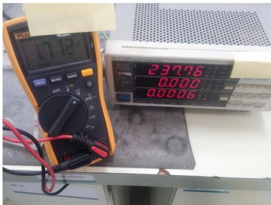
Figura 39 - Medição com a tensão acima da nominal
