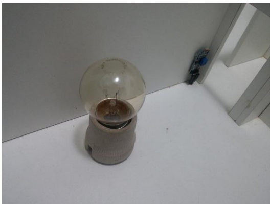
Figura 63 - Lâmpada dimerizada com sensor LDR
