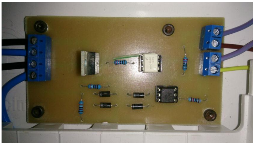
Figura 47 - Placa de controle do dimmer
