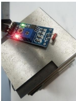
Figura 24 - Teste com o LDR
