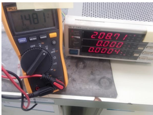
Figura 40 - Medição com a tensão abaixo da nominal
