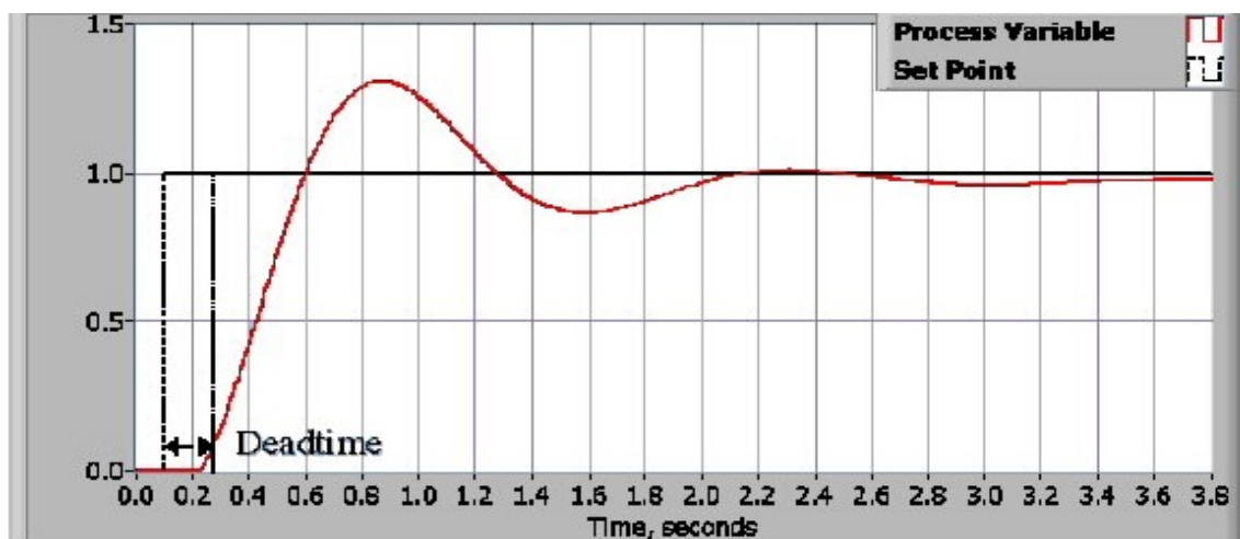
Figura 8 Resposta de um loop de um sistema de malha fechada com dead time
