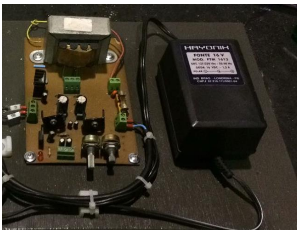
FIGURA 20 – Fontes reguladoras de tensão 12V e 16V Fonte: Autor
