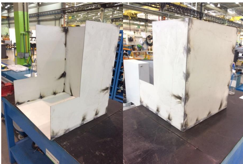
FIGURA 15 – Estrutura do protótipo após solda das chapas metálicas Fonte: Autor
