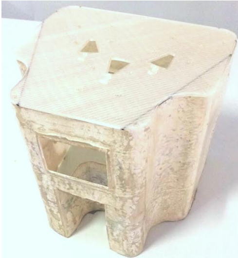
Figura 12 - Carcaça feita na impressão 3D. Fonte: Elaborada pelos autores.
