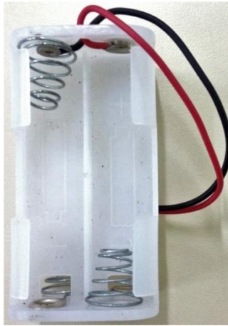
Figura 30 - Porta pilhas. Fonte: Elaborada pelos autores.
