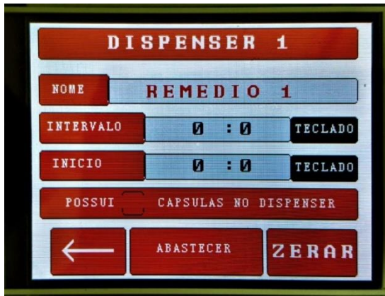
Figura 23 - Tela de configuração do DISPENSER . Fonte: Elaborada pelos autores.
