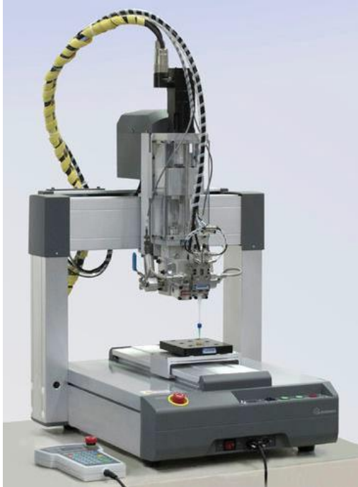
Figura 1 – Robô cartesiano projetado para realizar dosagens. Fonte: http://www.directindustry.com/pt/prod/nordson-industrial-coating-systems/product-25293-1844428.html Acesso em: 08 de abril de 2017.
