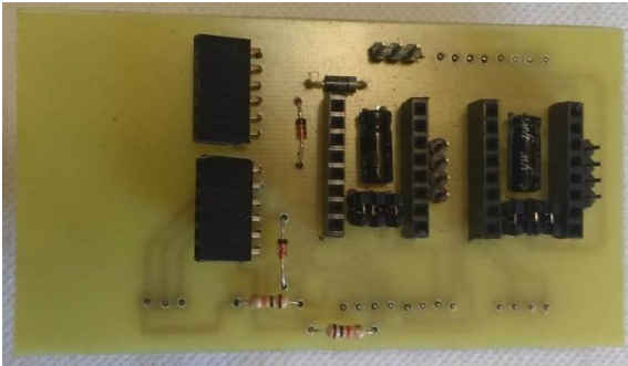
Figura 32 – Placa de comando montada Fonte: Autores
