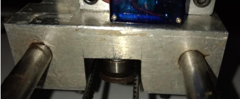
Figura 16 – Suporte frontal do eixo Y Fonte: Autores
