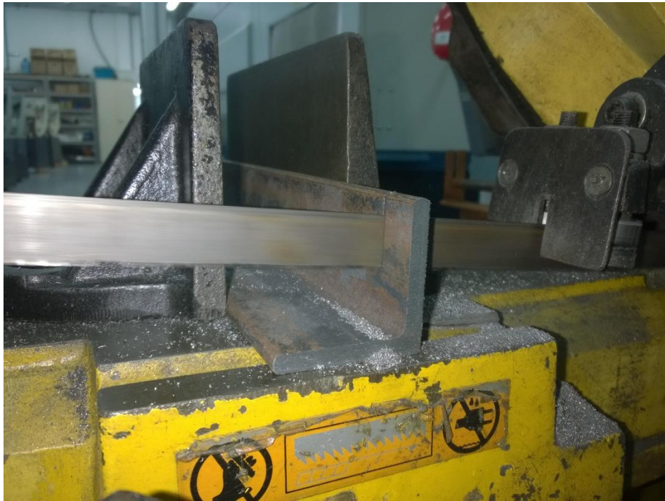
Figura 46 – Perfil “L” durante processo de secção
