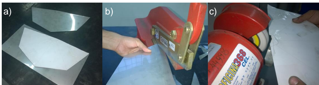
Figura 25 – Fabricação do Recipiente de Armazenamento.
