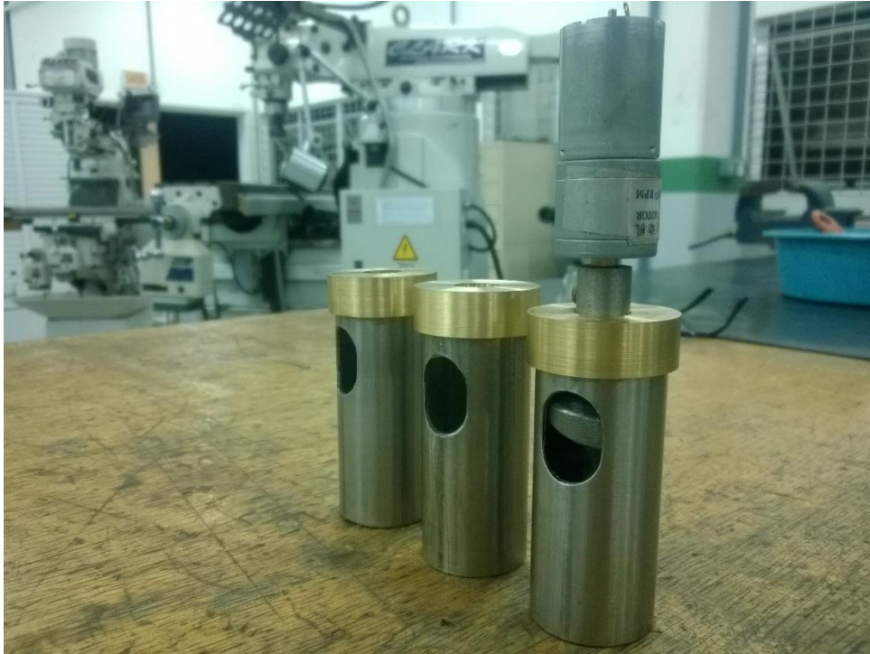
Figura 66 - Furo com dimensões inadequadas
