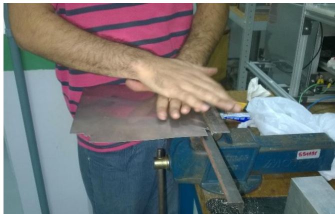
Figura 43 – Conformação das chapas do forno
