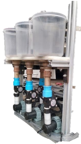
Figura 33 – Sistema de seleção de ingredientes líquidos
