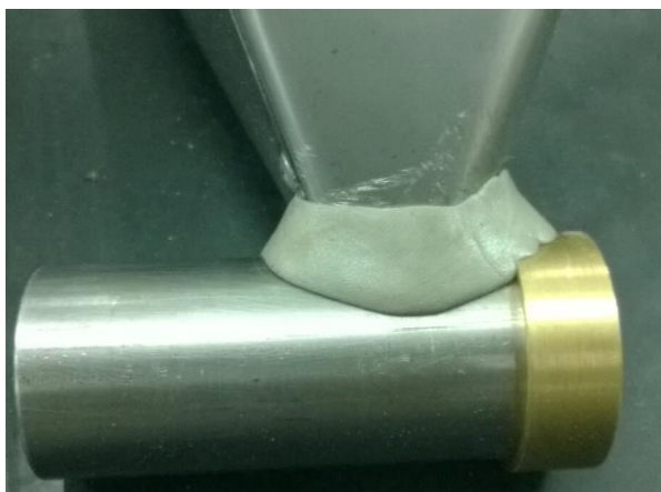
Figura 29 – União dos sistemas de armazenamento e dosagem de ingredientes sólidos com utilização de cola epóxi
