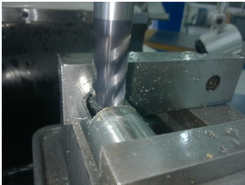
Figura 67 – Fresamento do tubo
