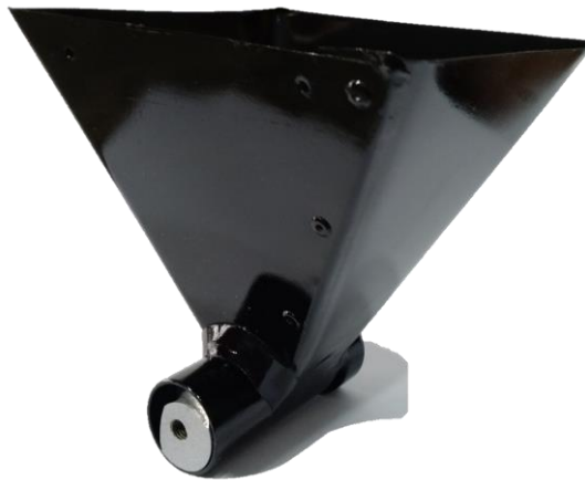
Figura 30 – Sistema de seleção de ingredientes sólidos com a pintura finalizada
