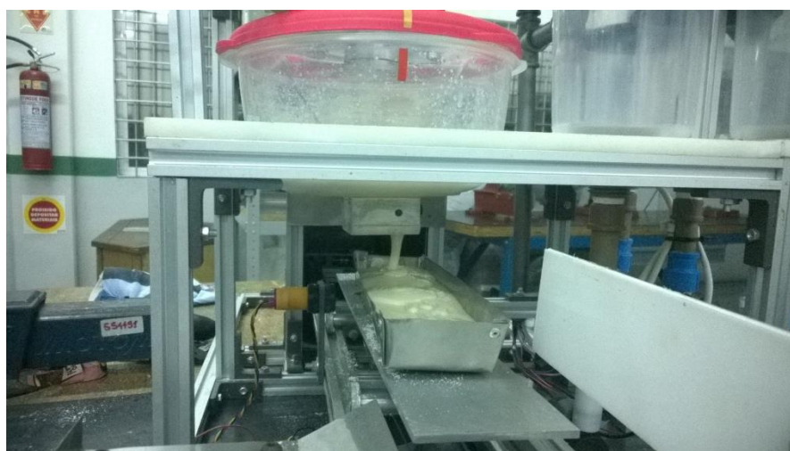
Figura 73 – Funcionamento da válvula dosadora
