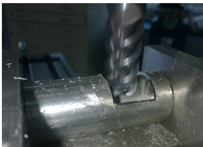
Figura 21 – Usinagem do Tubo Guia
