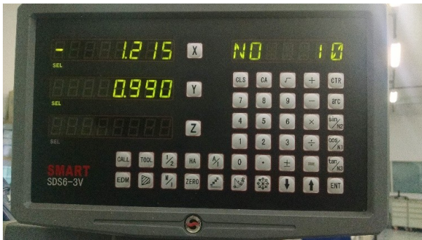
Figura 27 – Painel de controle – função múltiplos furos.
