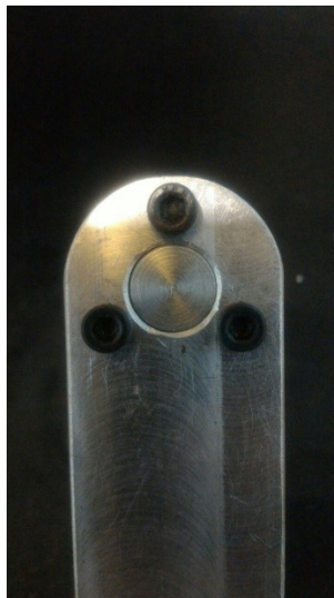
Figura 41 – Fixação entre barra e bucha. Fonte: Autores
