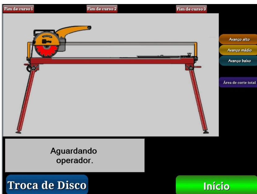
Figura 39: Aplicação Elipse Scada
