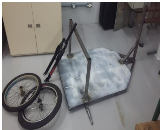
Figura 46 – Suportes dos amortecedores presos ao chassi.
