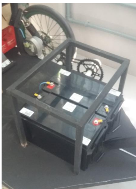
Figura 49 – Suporte do banco soldado ao chassi.
