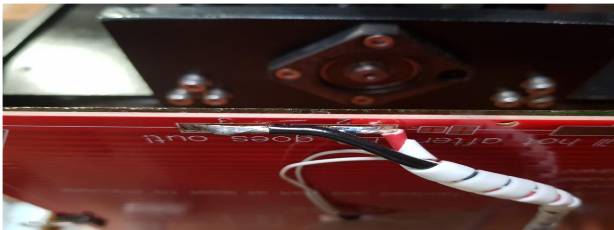
Figura 40 - Conexão mesa aquecida Fonte: Os autores
