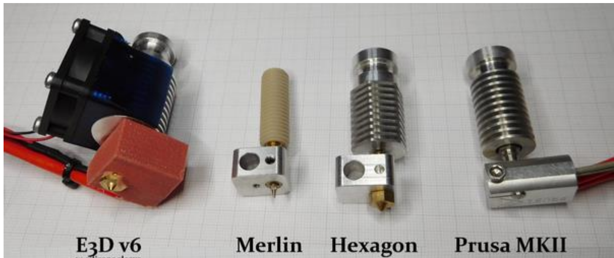
Figura 29 - Tipos de extrusor utilizados no ramo.
