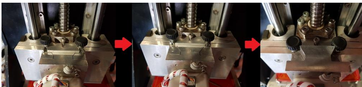
Figura 33 - Método de travamento cabeçote. Fonte: Os autores.
