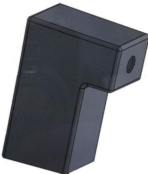
Figura 27 - Modelamento da proteção do motor de passo. Fonte: Os autores.
