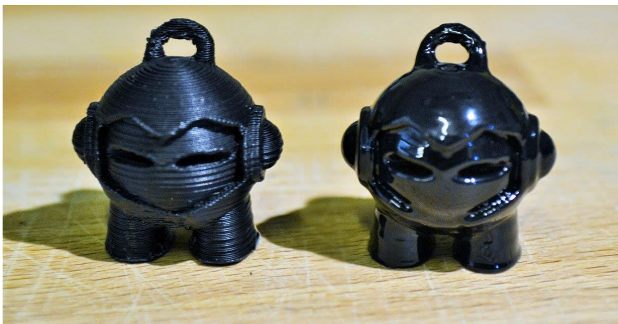
Figura 11 - Peça produzidas no processo FDM antes e depois do acabamento. Fonte: Disponível em < https://pinshape.com/blog/post-processing-your-pla-and-abs-prints/ > Acesso em 27 de Agosto de 2018.
