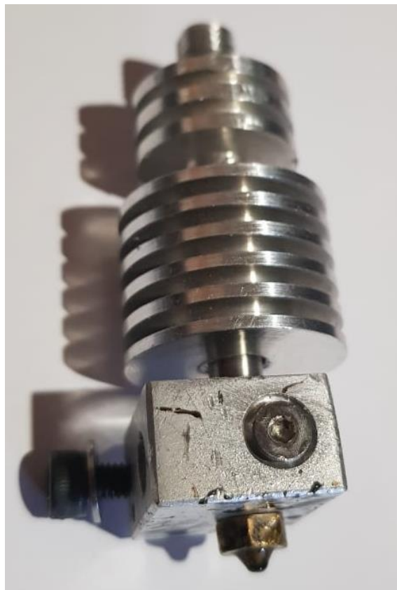
Figura 30 - Modelo de extrusor construído para o projeto.
