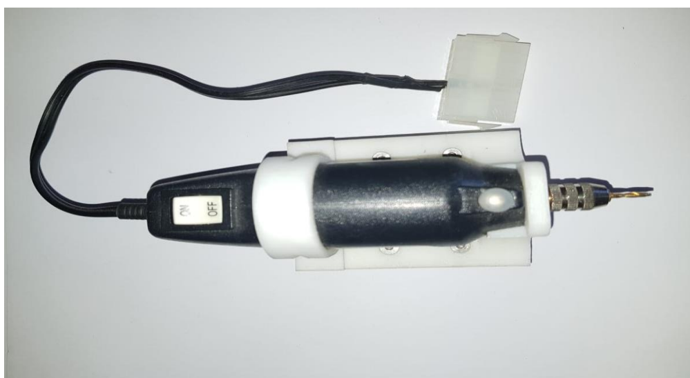
Figura 45 -Mini retífica e conector elétrico.
