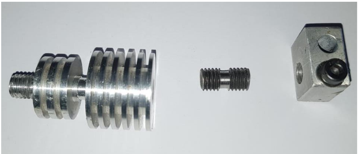
Figura 48 - Dissipador de calor desenvolvido.
