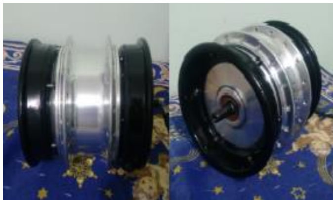
Figura 22 – Roda Fixada no Motor.
