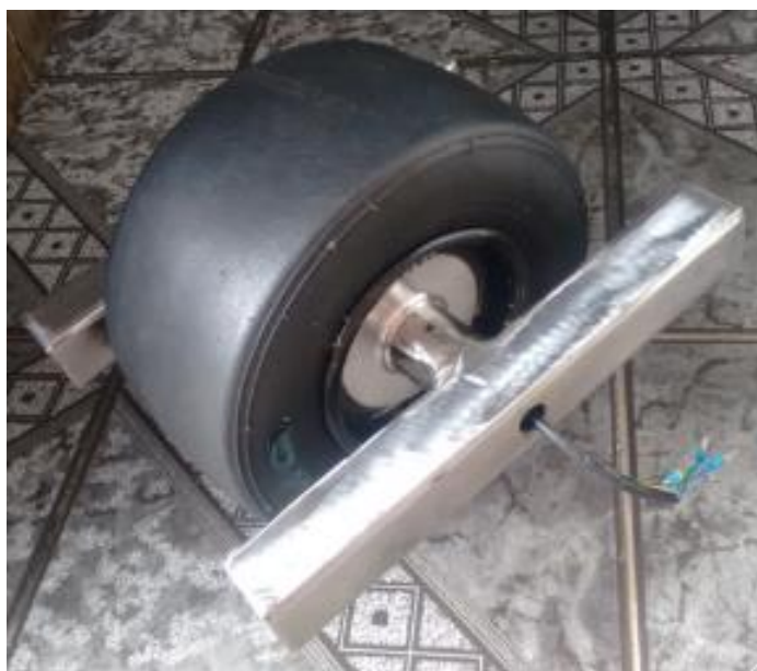
Figura 27 – Espaçadores Montados na Roda.
