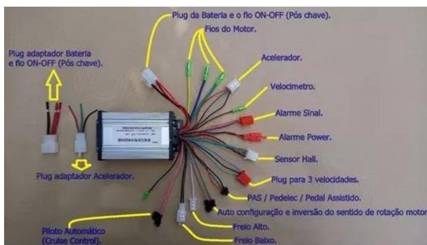
Figura 12 – Controlador de Bicicleta Elétrica.
