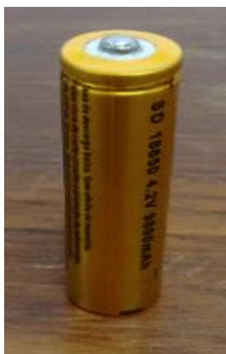
Figura 13– Célula de Li-ion.
