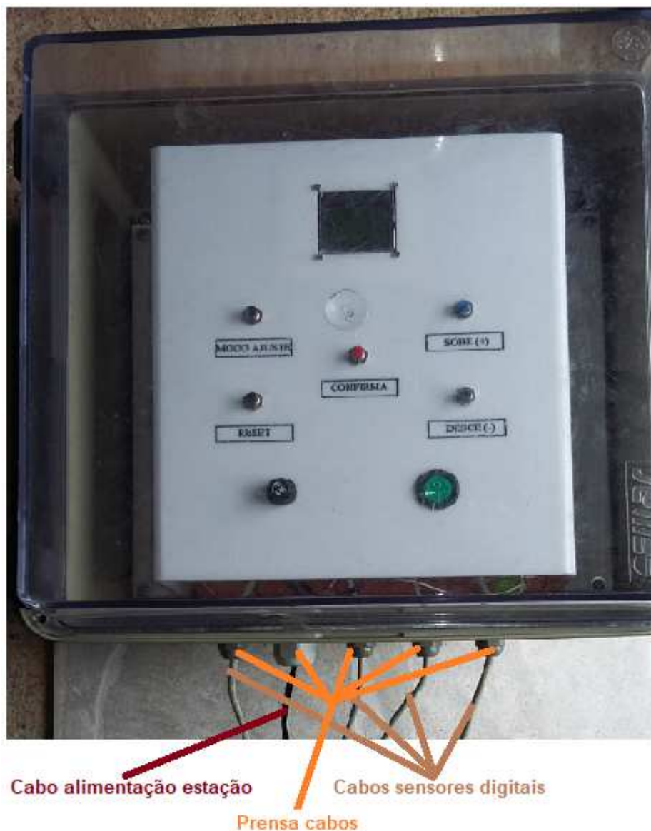
Figura 47 – Prensa cabos e os cabos dos sensores digitais e da fonte de alimentação
