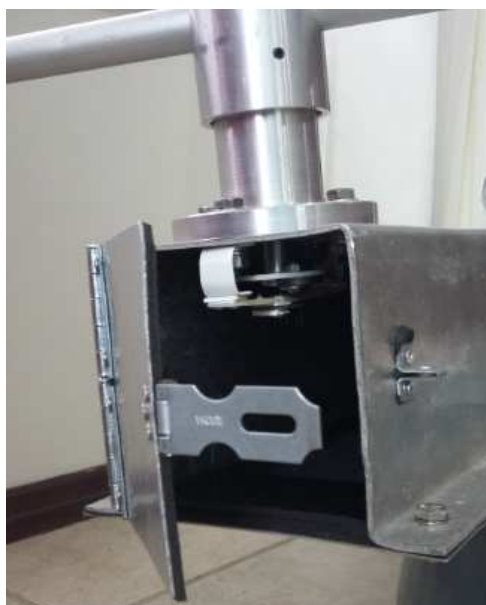
Figura 24 – Tampa móvel e fixa para acesso ao sensor de direção do vento
