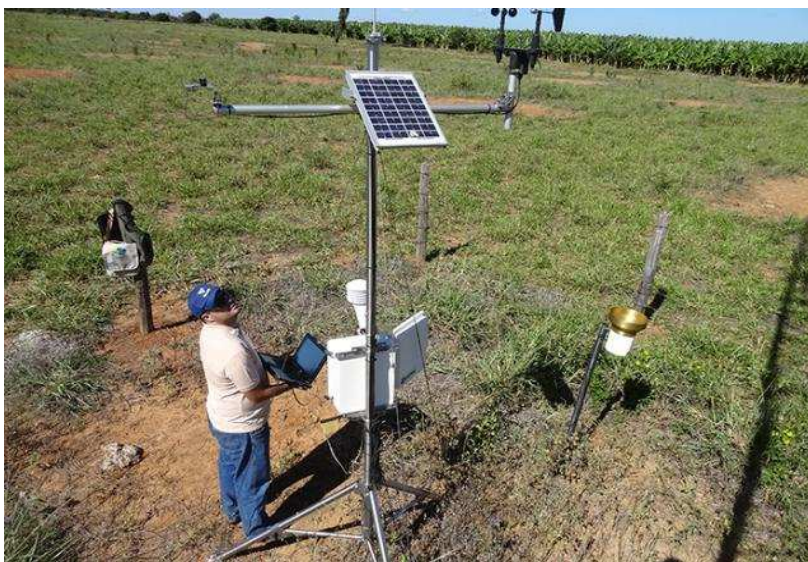
Figura 2 - Exemplo de estação meteorológica automática
