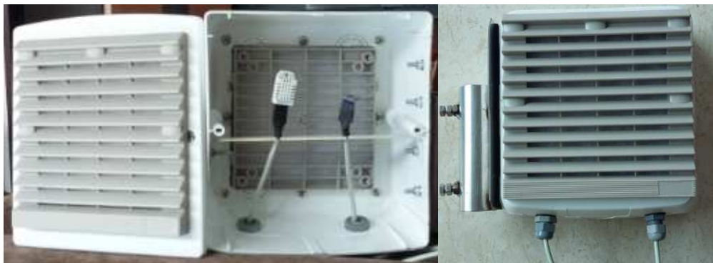
Figura 40 – Montagem da veneziana na caixa de passagem
