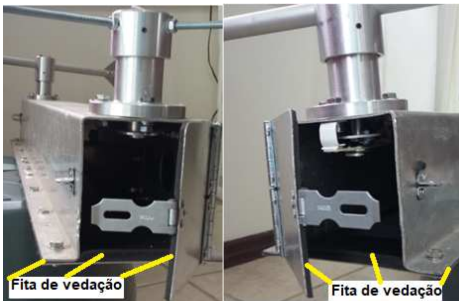
Figura 44 – Tampas de proteção móveis e tampa fixa com fita de vedação
