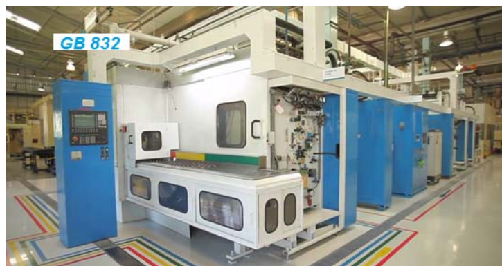
Figura 07 Máquina transfer GROB denominada GB 832
