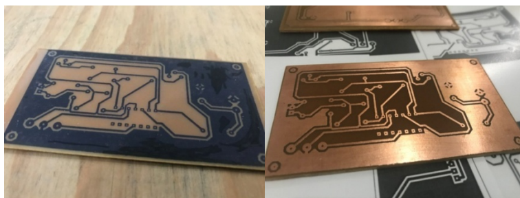
Figura 23: Placa após corrosão – Fonte: o autor.
