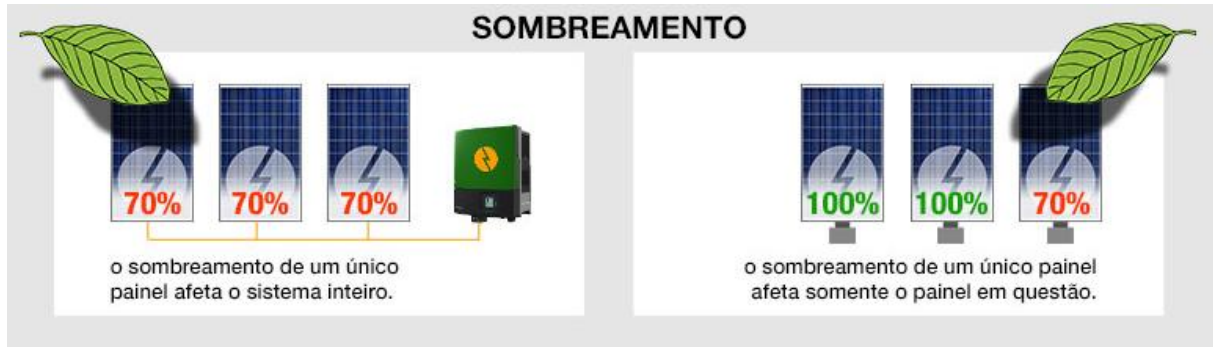
Figura 11 : Independência de um micro inversor.
