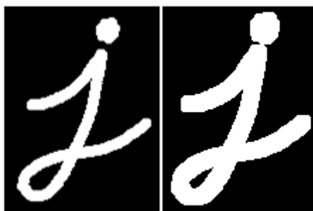
Figura 14: Exemplo de dilatação na imagem
