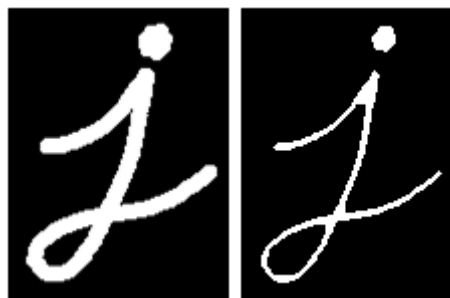
Figura 13: Exemplo de erosão na imagem
