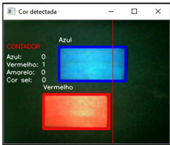
Figura 29: Peça identificada sendo contada ao passar pelo sensor virtual
