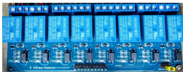
Figura 21: Módulo a rele 5V e 8 canais
