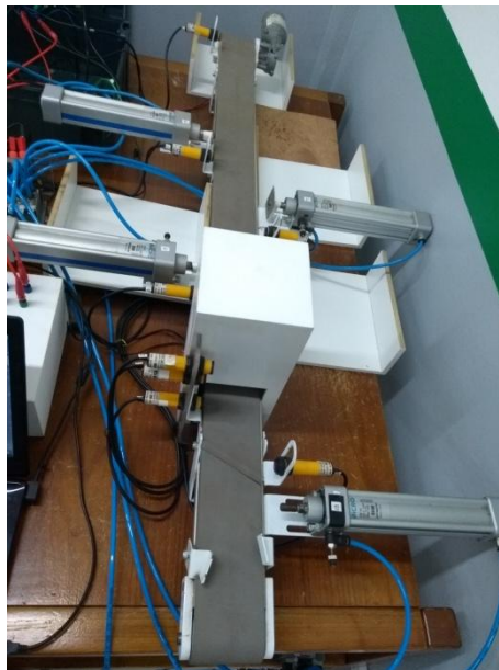
Figura 20: Esteira transportadora, sensores e cilindros pneumáticos
