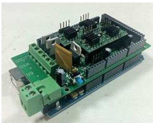
Figura 10: Placa RAMPS montada sobre uma placa Arduino Mega
