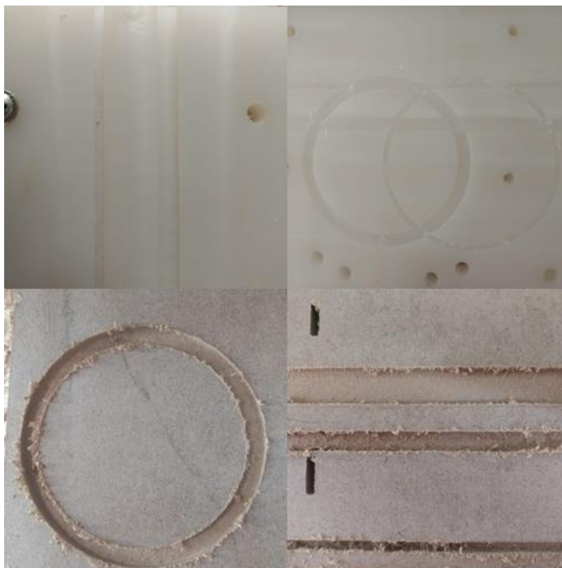
Figura 33 – Testes em PVC Sólido e MDF [Fonte: Autores,2020]
