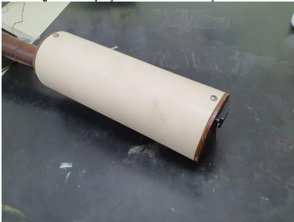
Figura 11 – Ampliação de caixa de acomodação do motor
