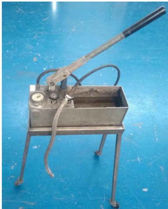
Figura 3 - Bomba hidráulica com reservatório
