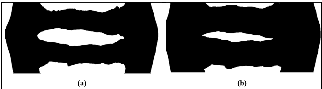
Figura 12 – Exemplo da aplicação da operação morfológica de erosão sobre uma imagem segmentada do cordão de solda. (a) Imagem antes da erosão. (b) Imagem após a erosão.
