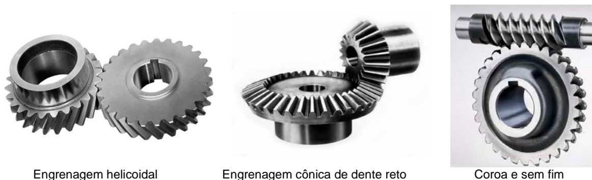
Figura 4-7: Engrenagem helicoidal, cônica de dentes retos e coroa e sem fim
