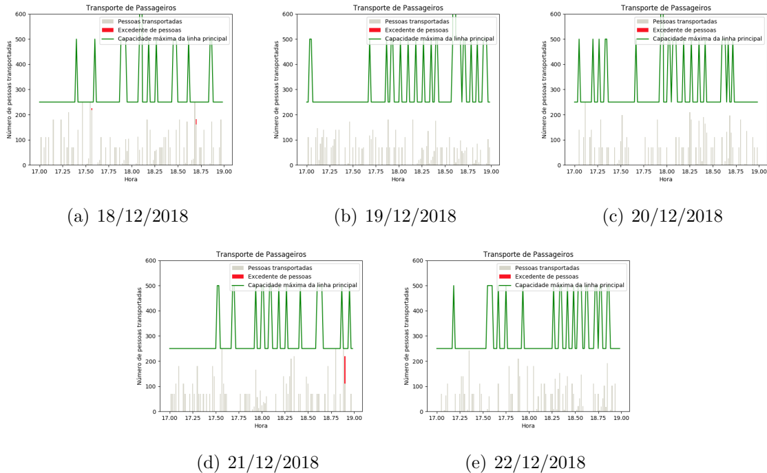
Figura 81: Passageiros em transferência no Terminal Campo Comprido das 17h às 19h
